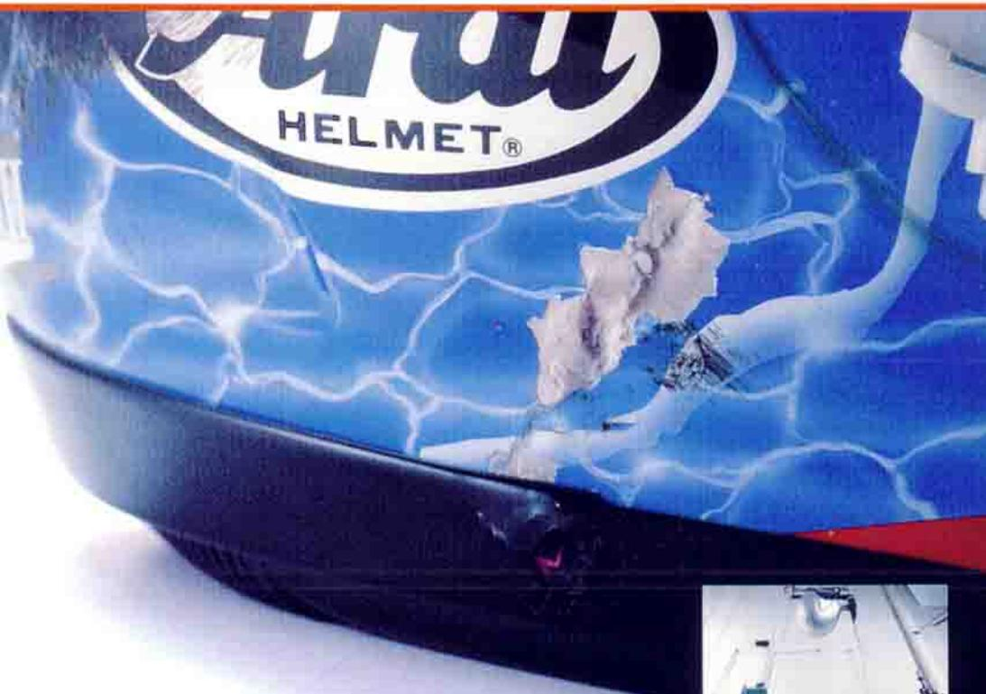
上の写真は、テストコースで、ワークスライダーが転倒した際に、マシンが上から覆い被さり、ヘルメットのスゾから5センチ位の箇所に、ステップが突き刺さったものです。もし、この製品が剛性の高いスネル規格品でなかつたら、あるいは、規格ぎりぎりで、スゾの方を薄くして、軽量化を計っていたものであつたらと考へると、ぞつとします。
