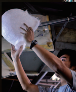
気象条件やサイズ等で帽体の厚さに影響するため、職人ひとりひとりが仕上がりを光にかざしてバランスを常に微調整する。
