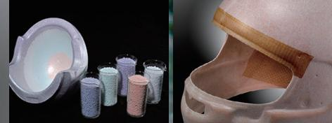
世界でいちはん厳しいとされるスネル規格を取得しながら、限りなくムダを省き、軽量に仕上げたシェル。サイドリブには、スーパー・ファイバーベルトを配置して、ヘルメット裾まで強靱に仕上げています。ダクト類はすべて両面テープで固定し、一方が一の際には衝撃で剥がれる設計で、「かわす性能」にこだわったアライならではの丸いフォルムを貫いています。さらに、アライ独自の多段階発泡一体成型ライナを使用し、ムダな厚みを設けることなく、コンパクトで滑らかなフォルムを実現。アライがこだわり貫いた安全性能に、新開発の空力特性や被り心地をプラス。
