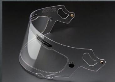
シールド内側に装着することで、シールドとシートの上に空気による断熱層をつくり、内外の温度差を平準化させシールドの曇りを抑えます。さらに、親水性のある特殊素材のシートが湿度に応じて吸湿・放湿を繰り返し、優れた防曇効果を発揮します。
